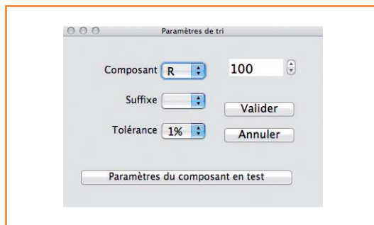
Bild 2b. Die Funktion Sorting vergleicht die Messwerte mit den hier eingegebenen Herstellerangaben.
