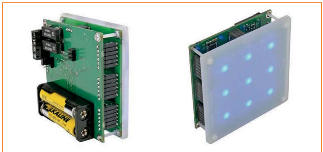
Bild 10. Die Steckverbinder werden von unten eingelötet, um die Montage der Plexiglasscheibe auf dem Tastenfeld zu erleichtern.
